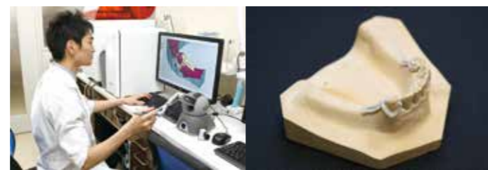
現在もCAD/CAMの機械は市販されているが、より普及すれば治療で型取りをすることもなくなるのだから。写真右はスーパーエンジニアリングプラスチックを使った部分床義歯のパーツ。
